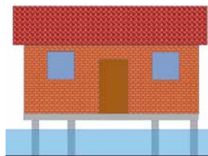
FIGURE 9 : principe de sur-élévation sur pilotis – Source : production des auteurs, 2022.
