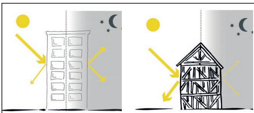
FIGURE 10 : Schématisation de l'effet d'absorption et de restitution de l'irradiation solaire dans des bâtiments en pan en béton (à gauche) et en pan de bois (à droite) – Source : Illustration de Céline Fréchet.
